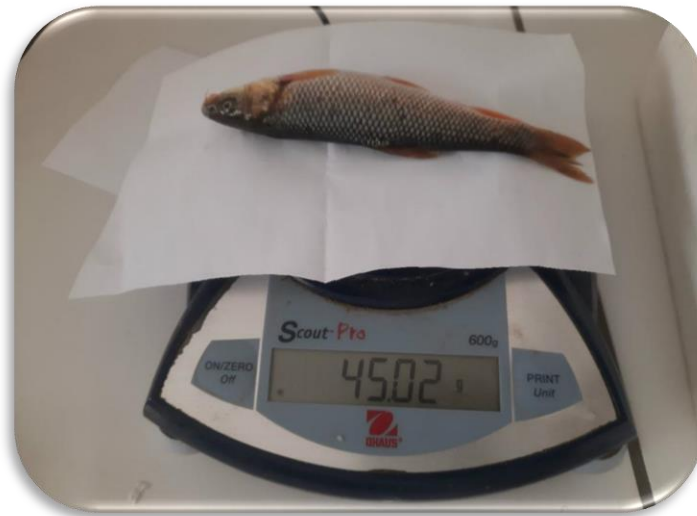
Figure 13 : Méthode de pesé des espèces (Une balance de type Scout pro (OHAUS) ayant une précision de 10^{-2} g) (Photo originale, 2022).
