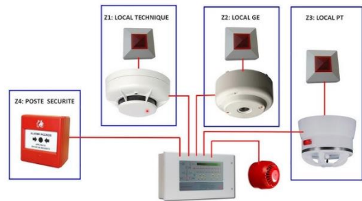
Figure 175 : Systèmes de détection incendie intelligents (SDI) Source : https://www.sapien.fr
