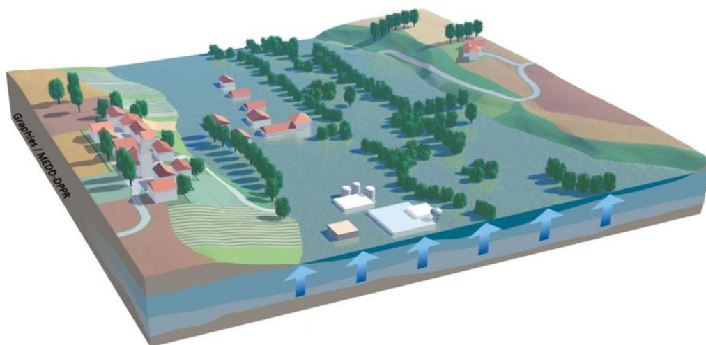
Figure I.5 : Inondation par remontées des nappes phréatiques.
