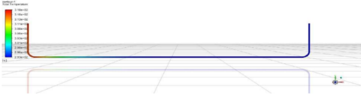
الشكل 28 : تطور درجة الحرارة داخل الأنبوب
