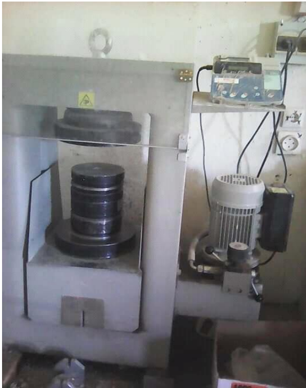
Figure III.6 Photos de la presse automatique
