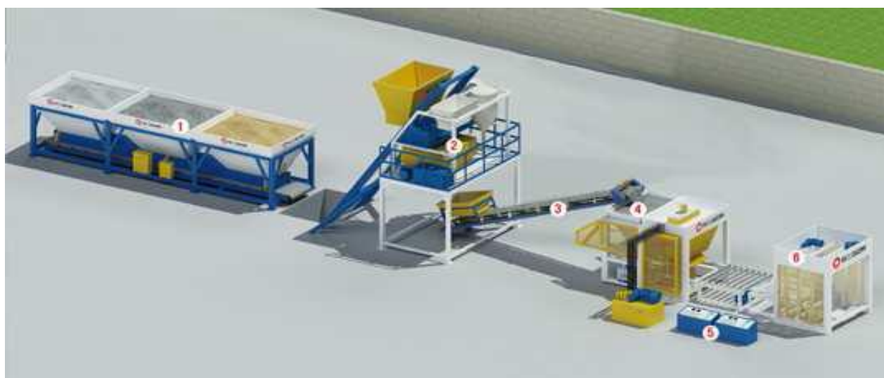
FigI.10: Processus de fabrication des blocs en parpaing (QGM, 2014)
