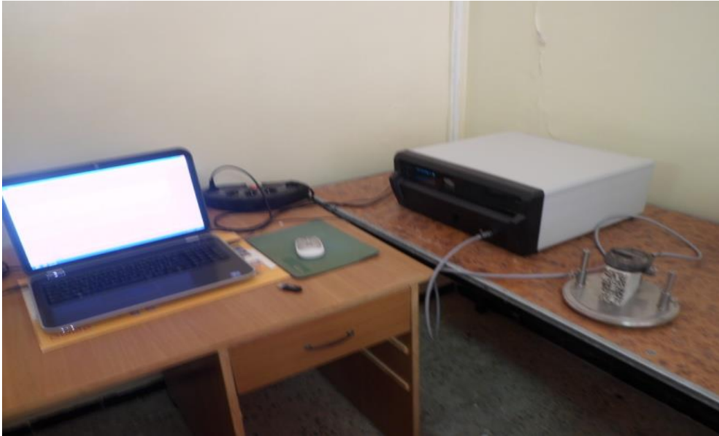
Fig II.9. Dispositif l'analyseur thermique Hot Disk TPS
