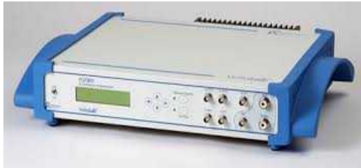
Figure III.4 : Potentiostat-galvanostat PGP201 (laboratoire mécanique)
