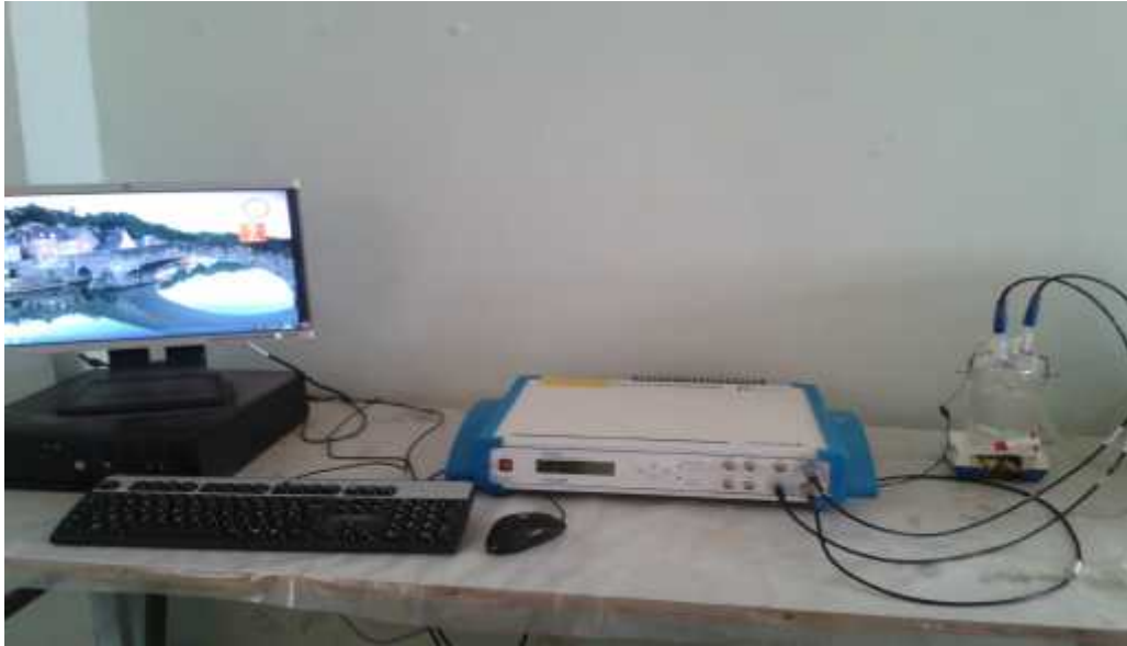
Figure III.9 : Dispositif Expérimental de la technique Potentiostatique
