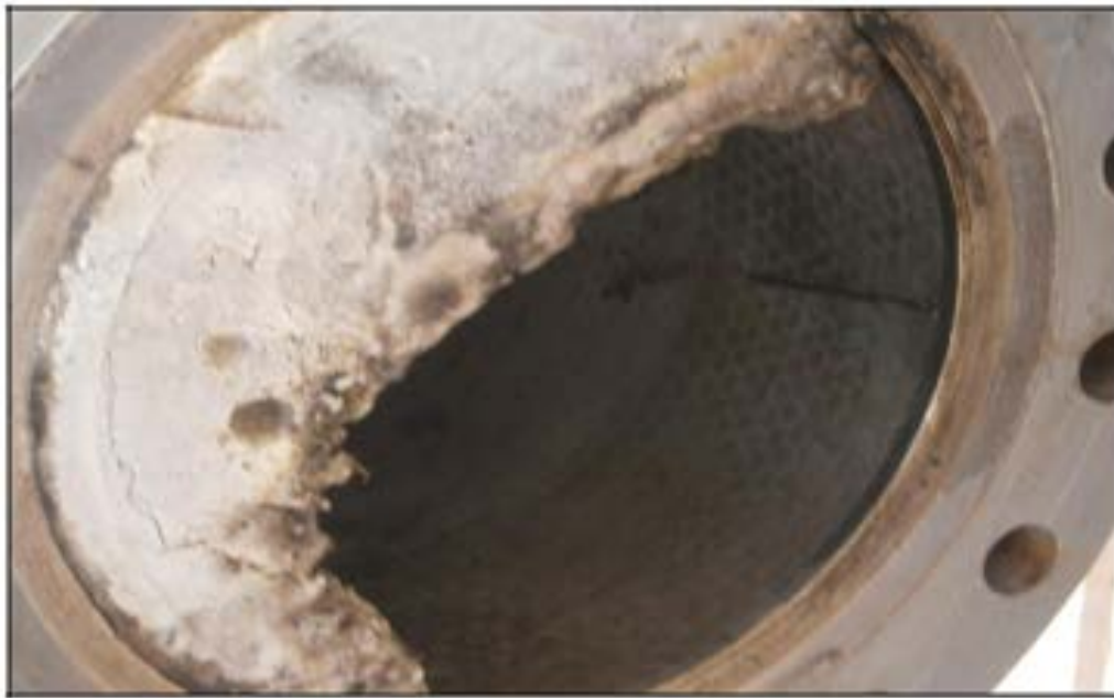
Figure 2.1: Formation des cristaux d'hydrates dans un filtre. Cas d'El merk.
