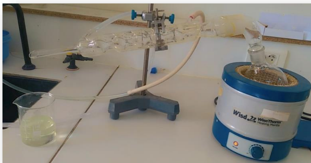
Figure 09 : Montage d'extraction par soxhlet
