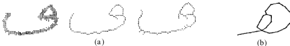
FIG. 2.3 – Illustration de quelques problèmes des algorithmes de squelettisation : (a) traits superflus dans le squelette ; (b) difficulté à représenter les boucles.
