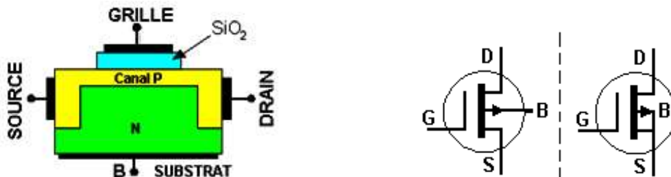
Figure IV.11 : Structure et Symboles d'un transistor MOS à appauvrissement de type P.
