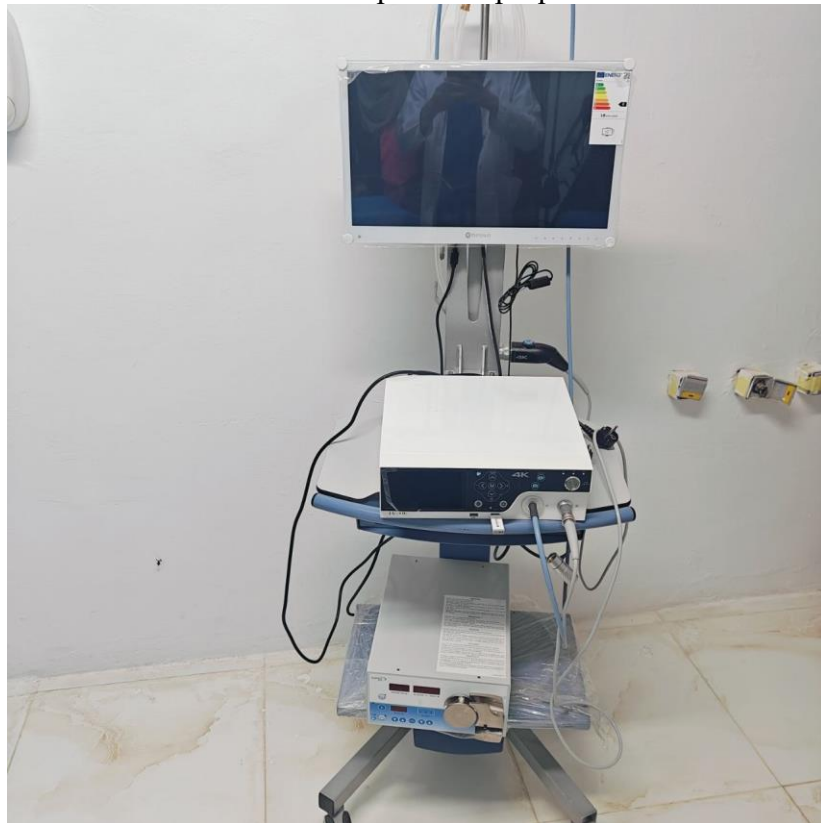
Figure 3 : unité mobile de vidéo-hystérocopie : moniteur de télévision ; caméra ; ; générateur de lumière froide ; chargeur
