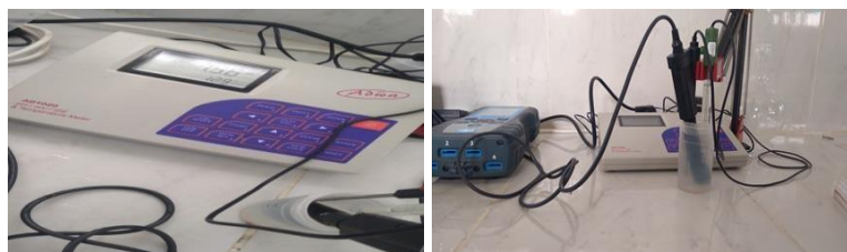
Photo.II.9 : pH mètre et thermomètre intégré (Cliché originale, 2023)
