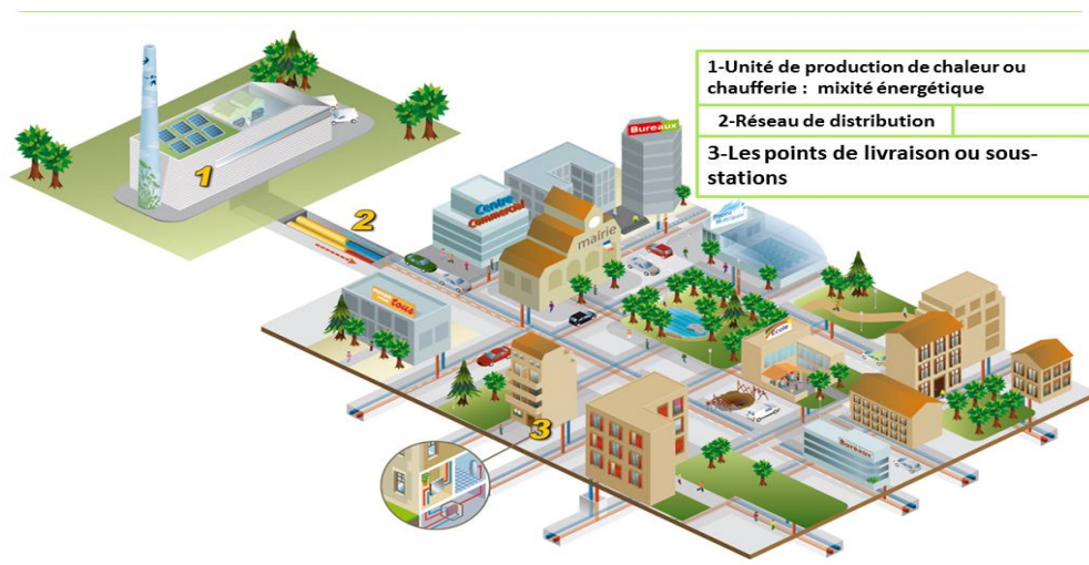
Figure II.12 : qui représente le chauffage urbain dans le quartier Vauban
