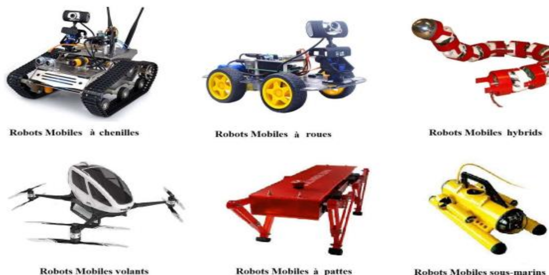
FigureI. 5: La classification des robots mobiles selon le type de locomotion.
