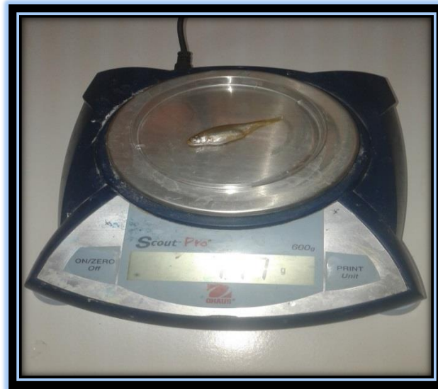
Figure 17 : L'appareillage utilisé pour la pesé des espèces (Une balance de type Scout pro (OHAUS) ayant une précision de 10^{-2} g) ( Photo originale, 2017 ).
