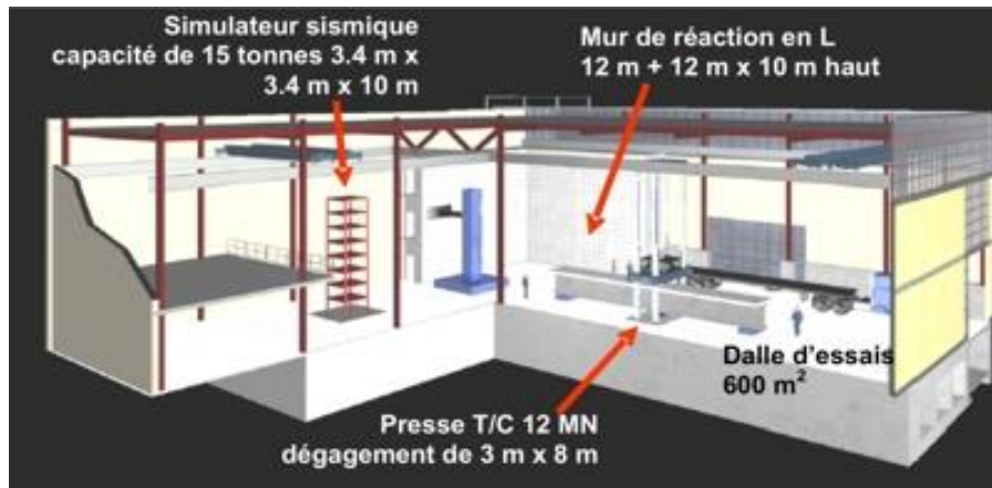
Fig III 07 : Laboratoires de structure
