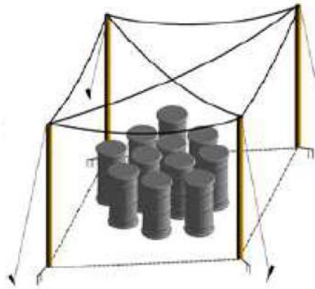
Figure I.10 : Renforcement des Paratonnerres par des fils tendus
