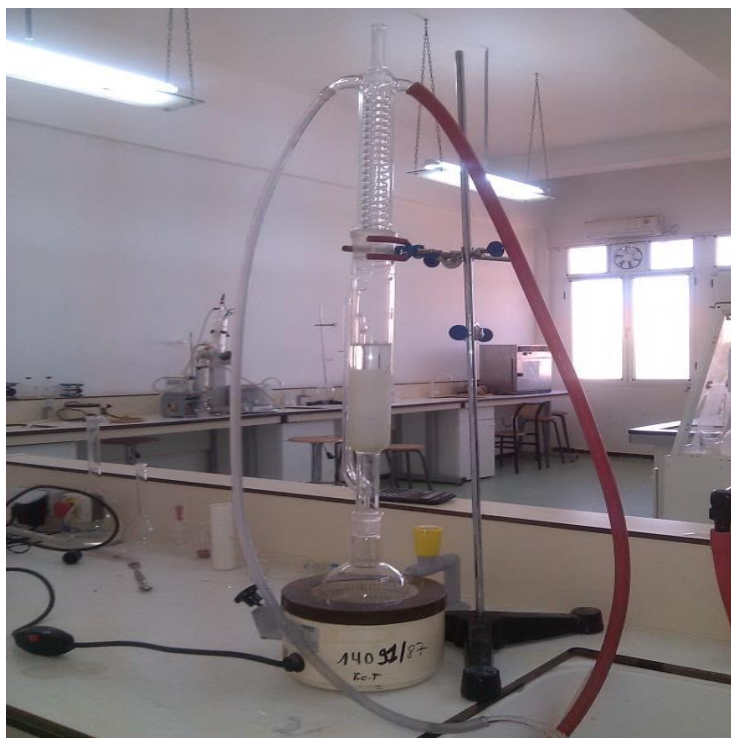
Figure I.1 : Montage d'extraction (Soxhlet) à chaud (solide –liquide) de l'huiles fixe
