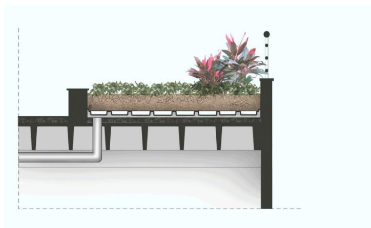
Figure 27 : schéma de la toiture végétalisée. (Campus da Fiocruz Ceará / Architectus S / S)
