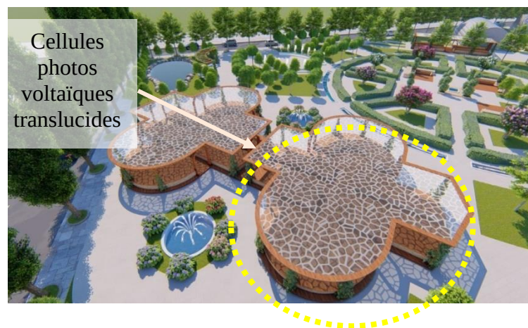
Figure 120 : Pergolas couvertes de verre photovoltaïques transparents ; Source : l'auteur.
