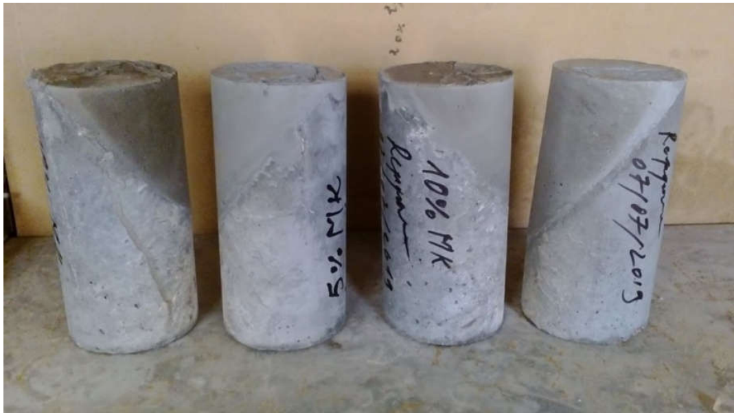
الشكل (2-21): العينات الاسطوانية الخرسانية بعد الترميم
