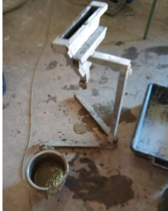
الشكل (2-10) يوضح ابعاد القمع الصغير على شكل حرف V
