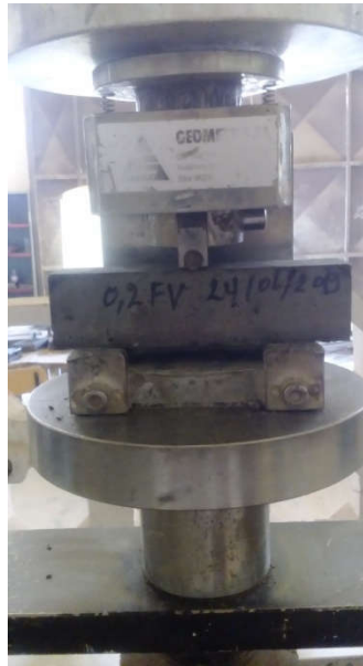
الشكل (2-13): يوضح تجربة الانحناء البسيط
