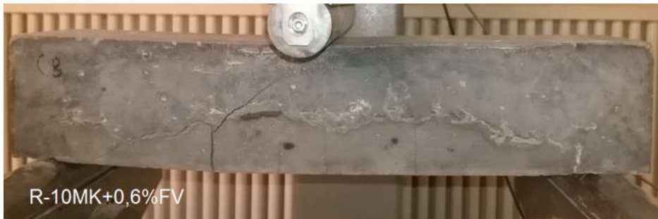
الشكل (16-3) صور العينات بعد تجربة الانحناء بثلاثة نقاط
