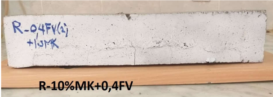
الشكل (3-18) صور العينات بعد تجربة الانحناء بأربع نقاط
