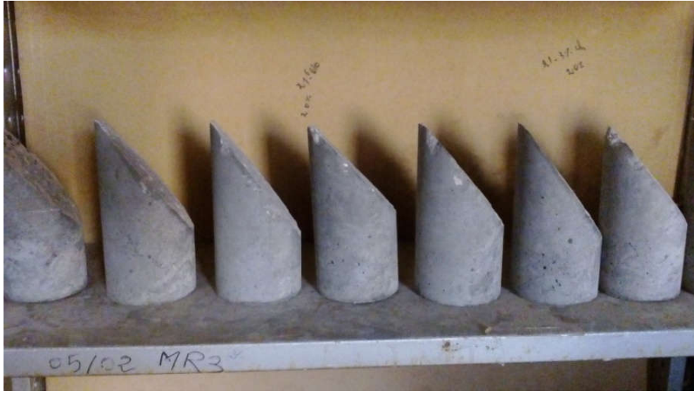
الشكل (2-20): العينات الاسطوانية الخرسانية بعد فك القوالب
