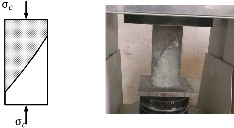
الشكل (16-1) تجربة القص المائل ( القص بواسطة الضغط).
