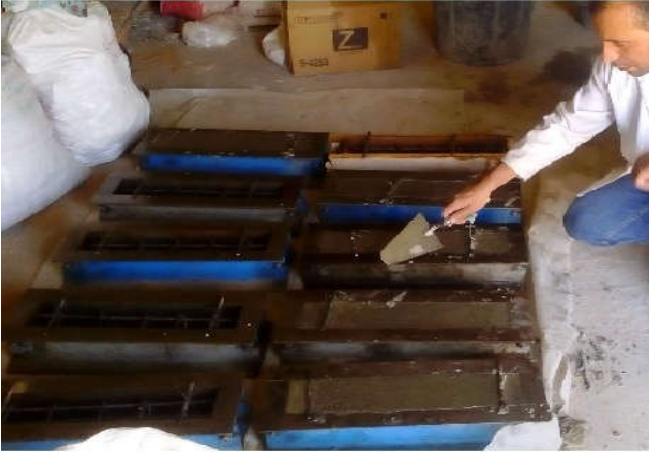
الشكل ( 2- 16 ): صب الخرسانة ذاتية الرص في القوالب
