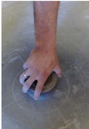
الشكل (9-2): تجربة الانتشار بالمخروط الصغير
