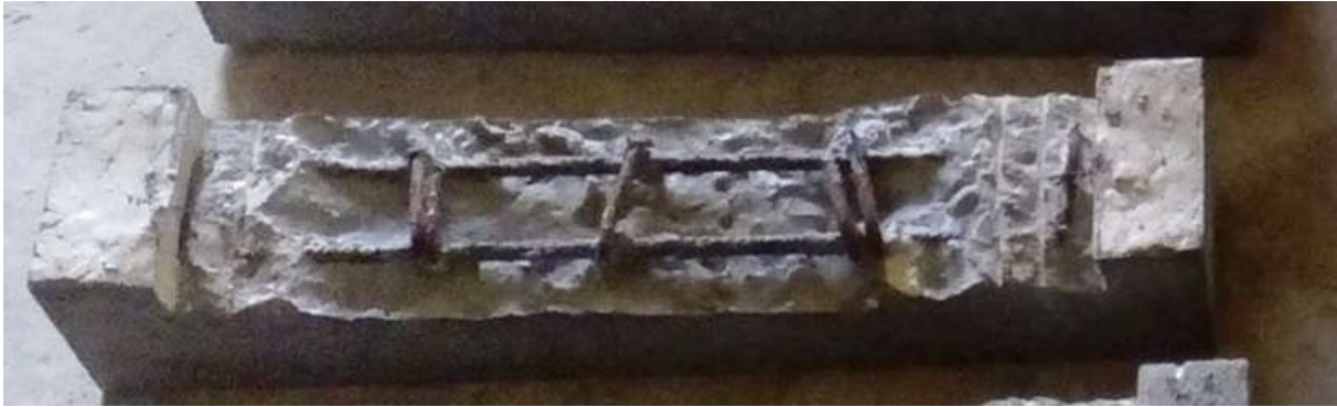
الشكل ( 2- 17 ): الروافد بعد التشويه و فك القوالب
