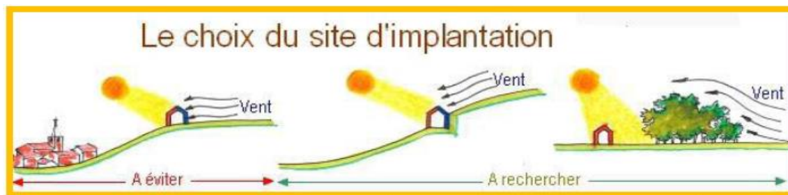
Figure : 37. site d'implantation préférée. Source : www.ecorea.fr/construction
