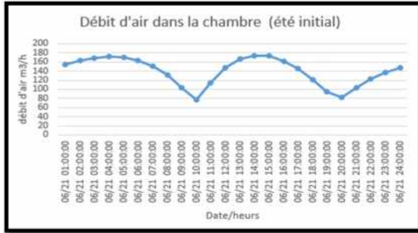
Figure27 : graphe de débit d'air de l'état initial en été source :
