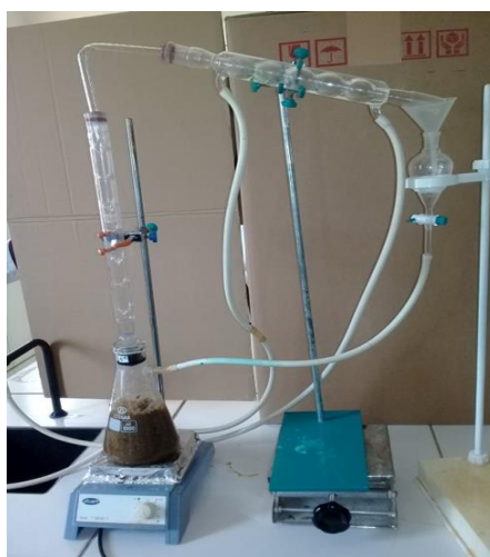
Figure 15 : Photo représente le montage d'hydrodistillation utilisé pour l'extraction de l'huile essentielle.
