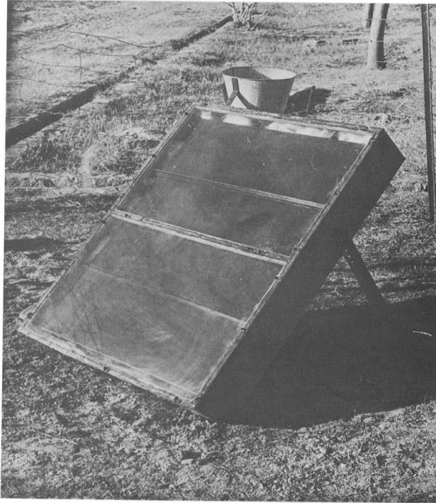
Figure 1. 17 : Photo du chauffe-eau solaire à stockage intégré adapté à une utilisation rurale [44]
