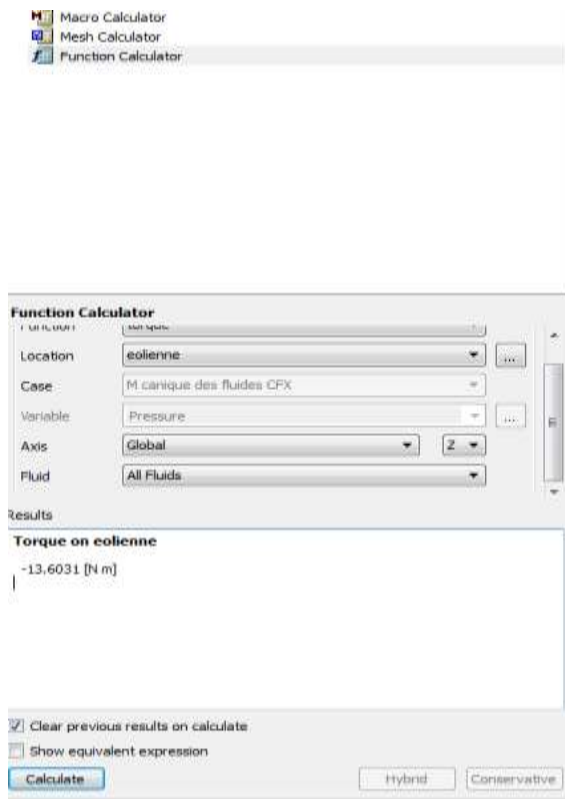
Figure V.14 utilisation de l'option function calculator pour déterminer le couple exercée sur l'éolienne
