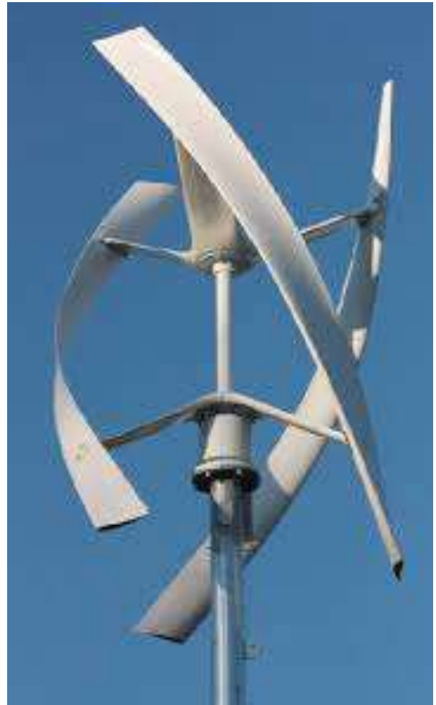
Fig. 1.9. Éolienne à axe vertical [11].
