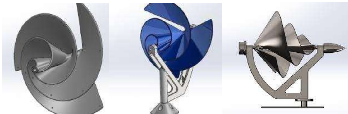
Figure V.1 Configuration d'une éolienne Archimède
