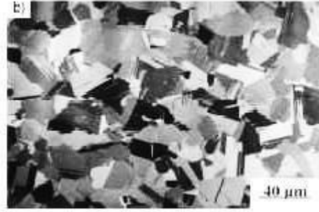
(b) : microstructure duplexe obtenue après un maintien de 2h à 1300\text{ °C} .
