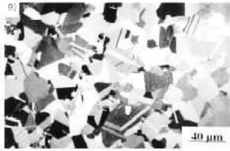
(a) : microstructure majoritairement \gamma obtenue après un maintien de 2h à T_2 = 1200\text{ °C} (à environ 750\text{ °C} au-dessus du palier eutectoïde).
