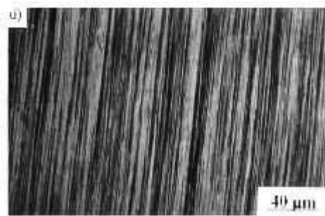
(d) : microstructure entièrement lamellaire obtenue après un maintien de 0,5h à 1400\text{ °C} (au-dessus de T_\alpha ).
