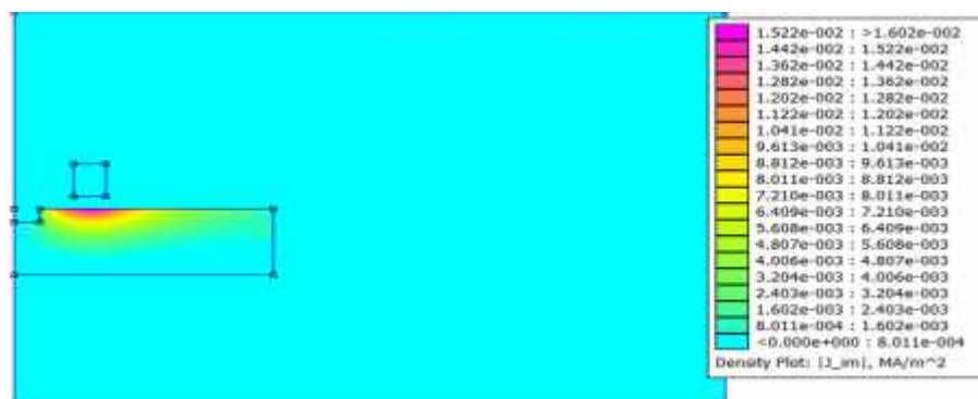
Figure IV.28 - Courants induits dans la plaque par FEMM
