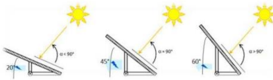
Figure II.10 : Inclinaison de 90^\circ par rapport aux rayons du soleil (au centre) = production
