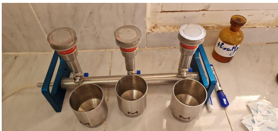
Figure 19: Appareille de filtration sur membrane
