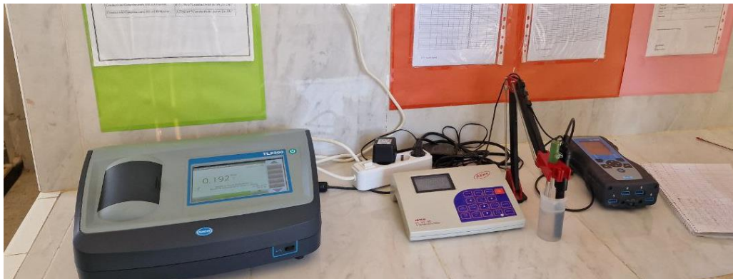
Figure 15: l'appareil multi- paramètre (HI 2550 pH/ORP et EC/TDS/NaClMeter de marque Huch)
