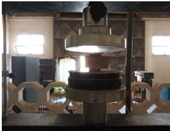
Figure 1.8. Essai de résistance à la compression.
