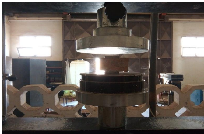
Figure 4.24. Schématisation du dispositif de compression.
