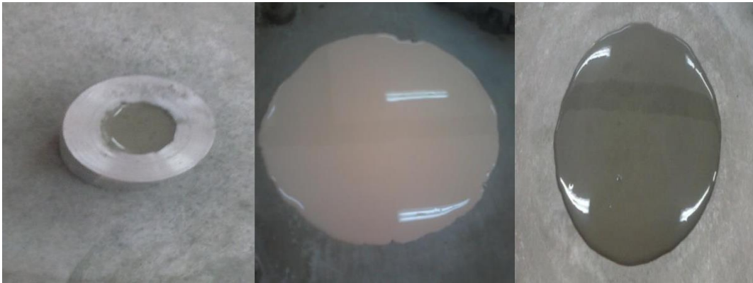
Figure 1. 6. Étapes de l'essai d'étalement au Mini cône de pâte.
