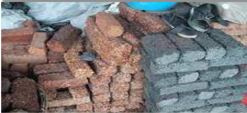
Figure 3.3. Pavés à base de sachets recyclés
