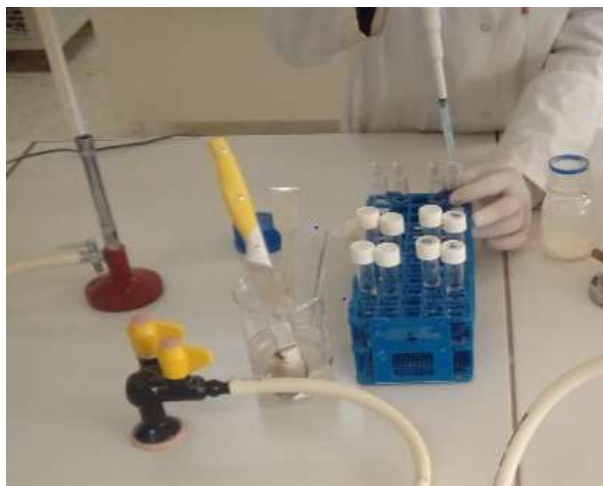
Figure 13 : Préparation de la solution mère et des dilutions décimales (Photo originale 2021)
