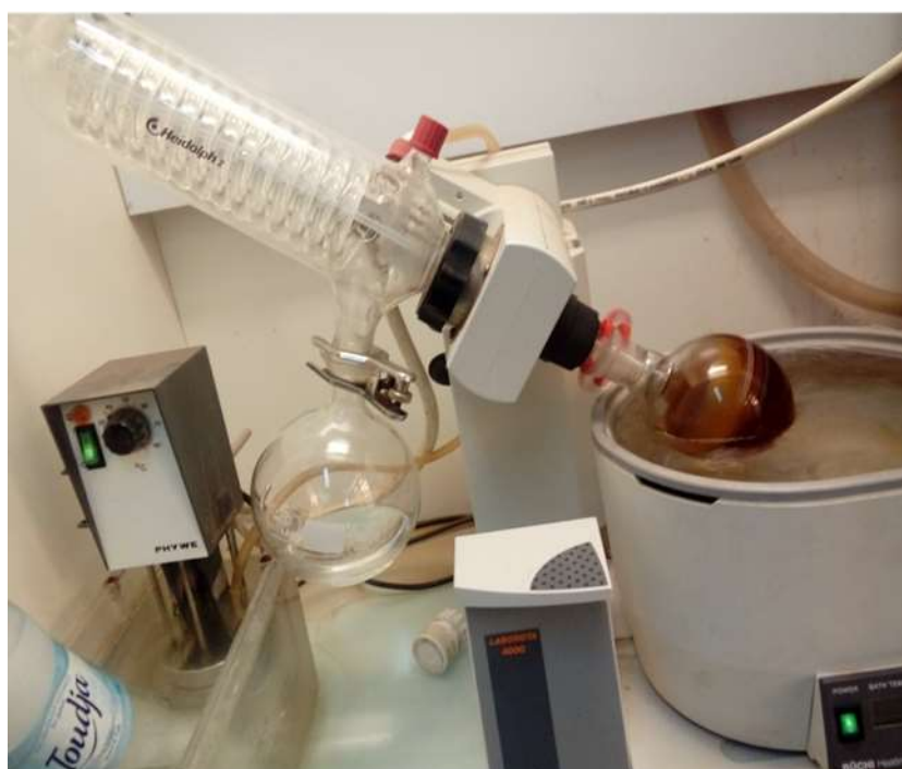
Figure 7 : Evaporation de l'éthanol à 50°C dans un évaporateur rotatif de type Heidolph Rotary Evaporator, Laborota 4000 (Photo originale, 2021)
