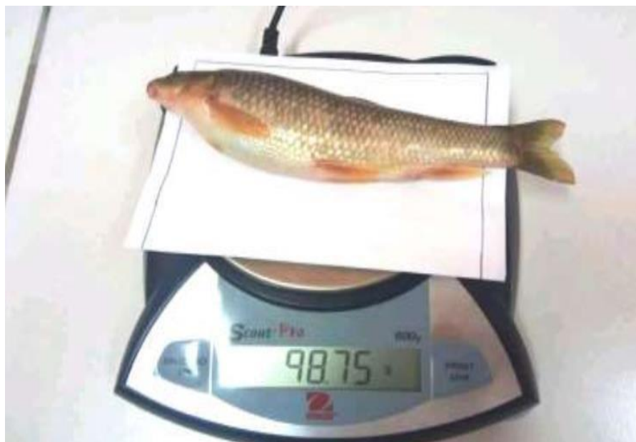
Figure 13: L'appareillage utilisé pour la pesée des espèces (Une balance de type Scout pro (OHAUS) ayant une précision de 10^{-2} g)(Photo originale, 2022).
