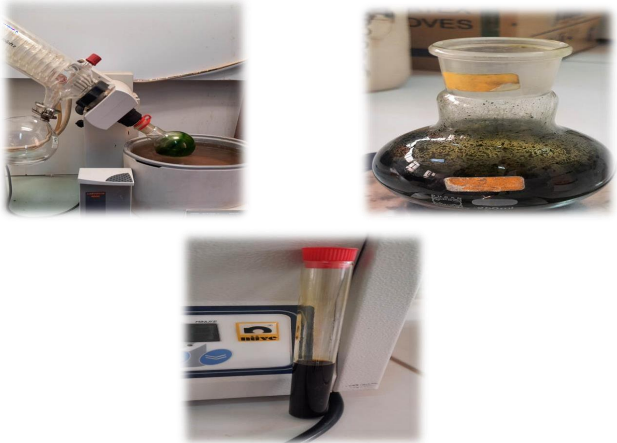
Figure 20 : Protocole expérimental d'obtention des extraits phénoliques (originale ; 2024)
