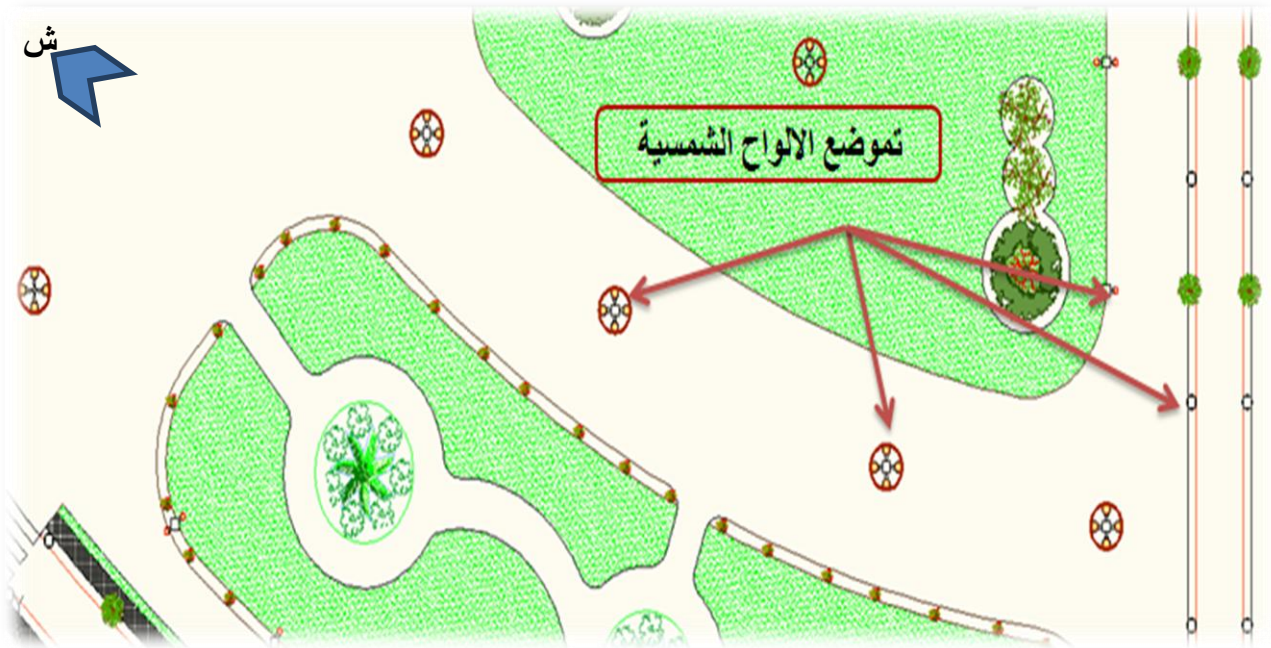
الشكل رقم 21: توضح تموضع الألواح الشمسية على مستوى الأعمدة الكهربائية المصدر: من إعداد الطالب.
