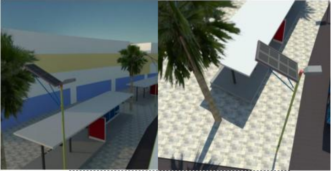
الصورة رقم 50, 51: توضح لتموضع 3D الألواح الشمسية على مستوى الأعمدة الكهربائية المصدر : من إعداد الطالب
