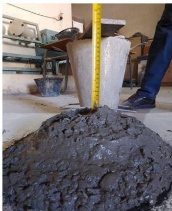
Photo II.7. Essai cône d'Abrams
