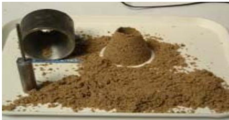
Photo II.4. Essai L'absorption de sable.
