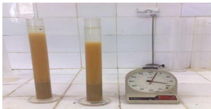
Photo II.3. Essai équivalent de sable.
