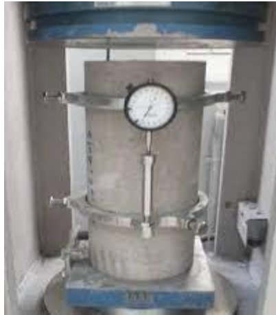
Figure III.1 Le dispositif utilisé pour déterminer le module d'élasticité.
