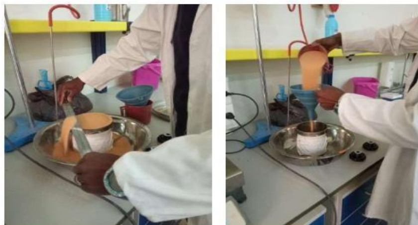
Photo II.2. Essai de Masse volumique apparente
