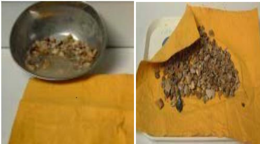
Photo II.5. Essai L'absorption de gravier.
