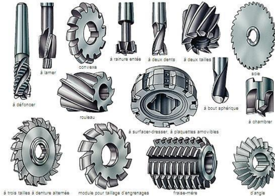
FIGURE I.21. DIFFÉRENTS TYPES DES FRAISES [5].
