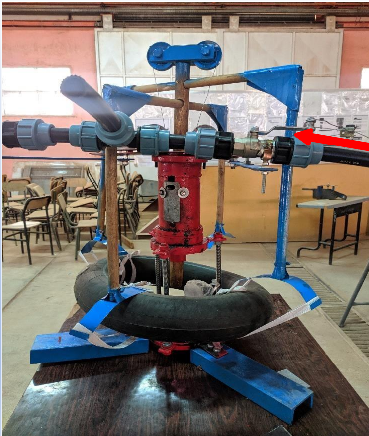
Figure 2.14: les bras horizontaux et verticaux fixés sur le manchon.
