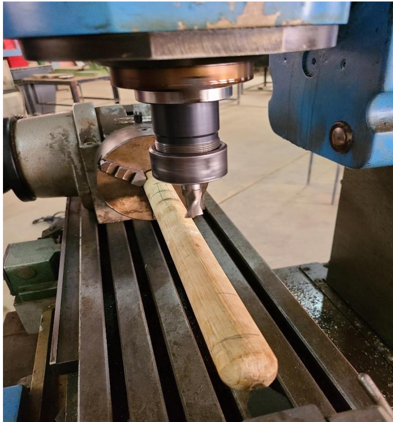
Figure 2.10: L'exécution d'une rainure sur la pièce porte manchon en bois.
