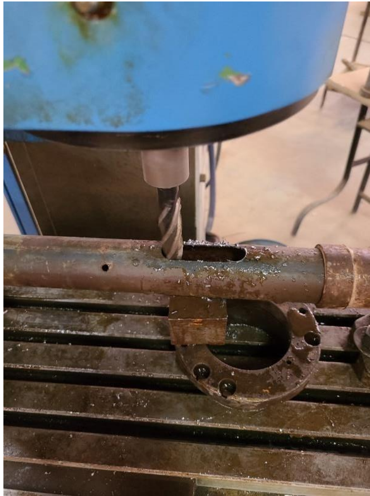
Figure 2.9: L'exécution d'une rainure sur la pièce porte manchon en bois.
