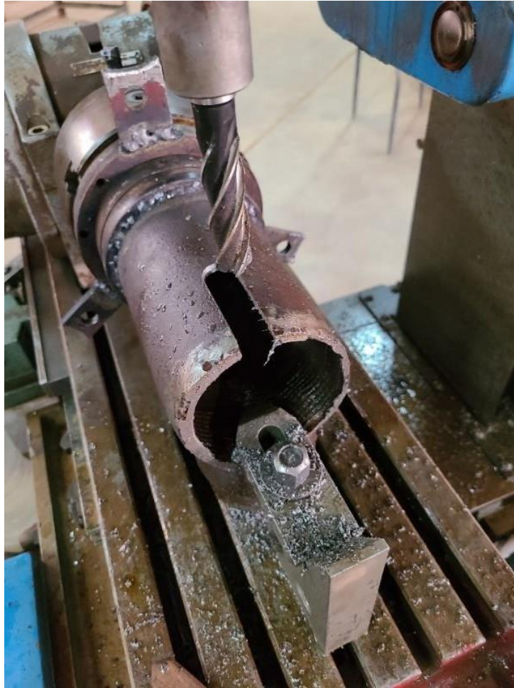
Figure 2.7: Exécution de la rainure sur la pièce 2 en utilisant une fraiseuse verticale.
