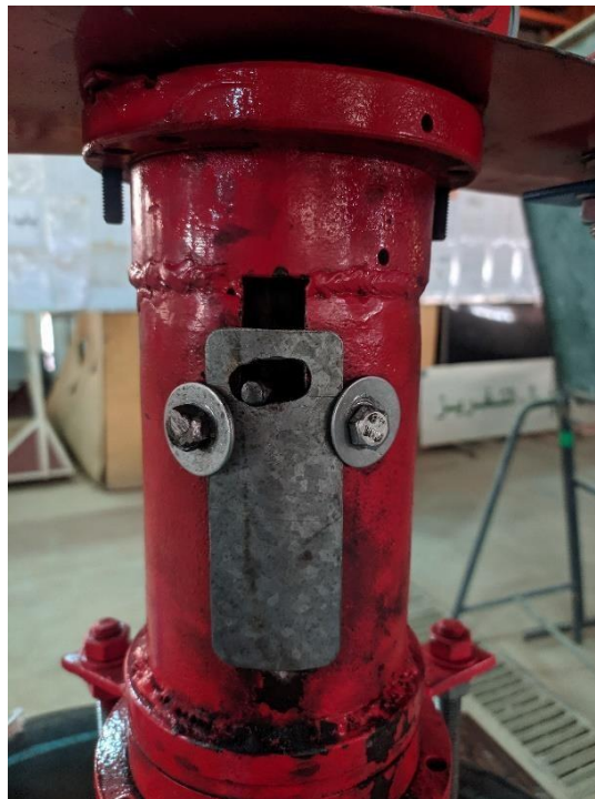
Figure 2.11: Plaquette de réglage de la hauteur d'eau
