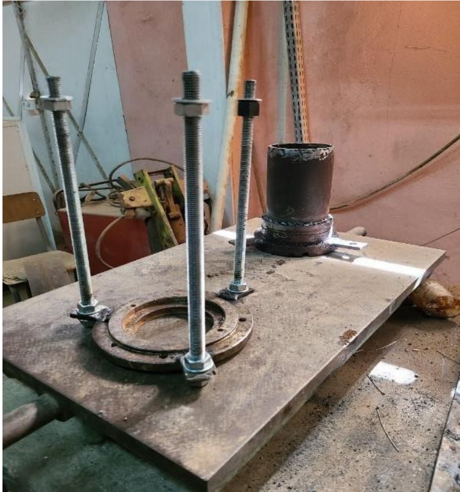
Figure 2.8: Montage des axes filetés avec la pièce 4 par le biais des pièces en fer plat.
