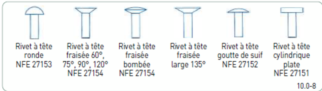
Fig. III-25: Exemples de rivets.
