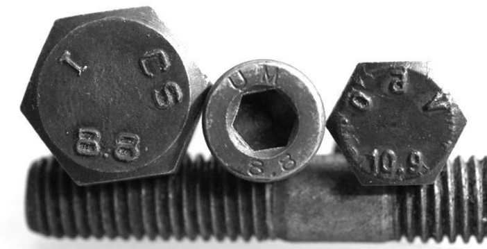
Fig. III-15: Exemple de classes de qualité gravées sur des vis.
