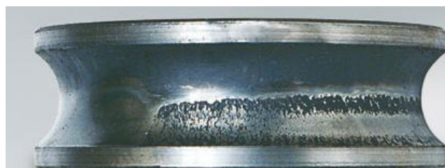
Fig. V-6: Exemple d'un écaillage d'une bague intérieure d'un roulement à billes à contact oblique.
