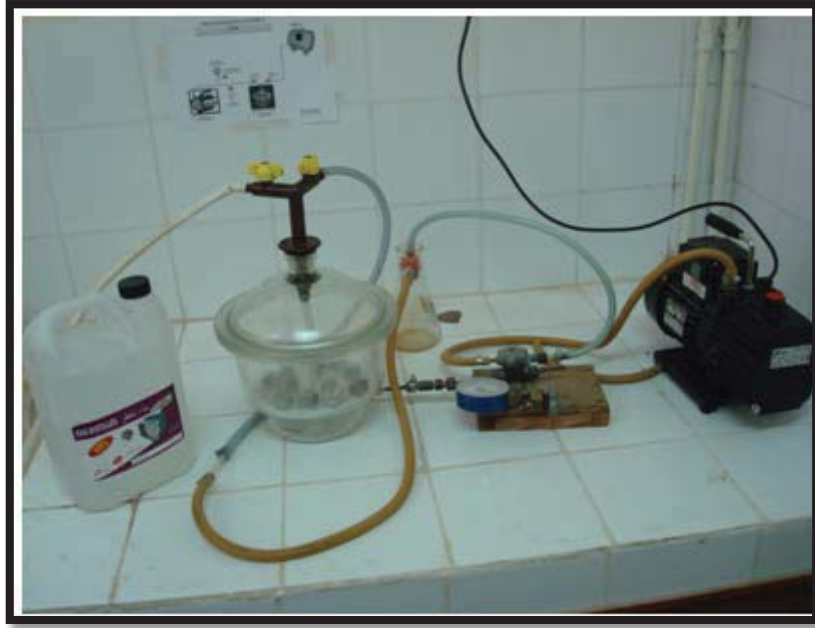
Photo II.17 : dispositif de l'essai accessibilité à l'eau
