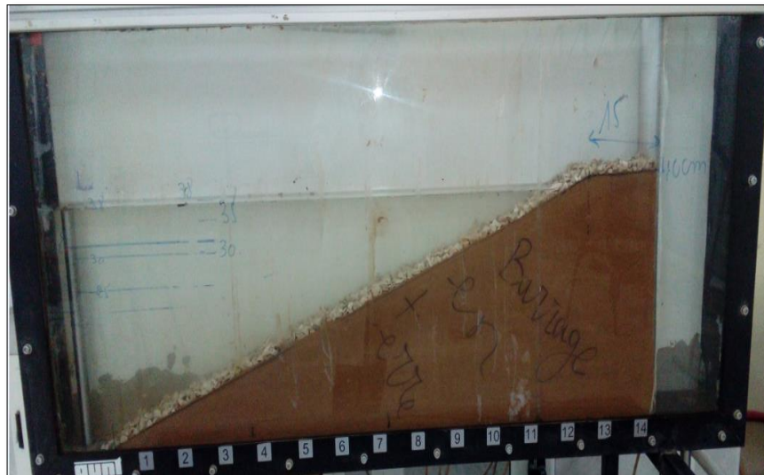
Photo. III. 3. Barrage en terre homogène sur une base imperméable (bc = 15 cm).
