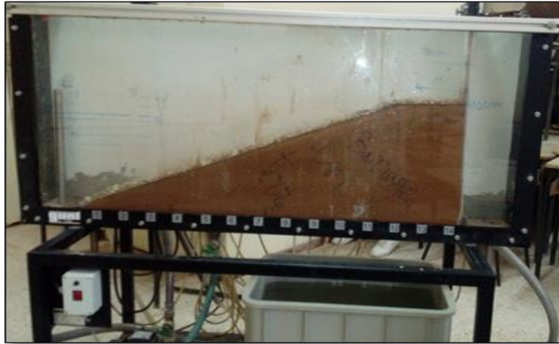
Photo. III. 4. Barrage en terre homogène sur une base imperméable ( bc = 20 cm).
