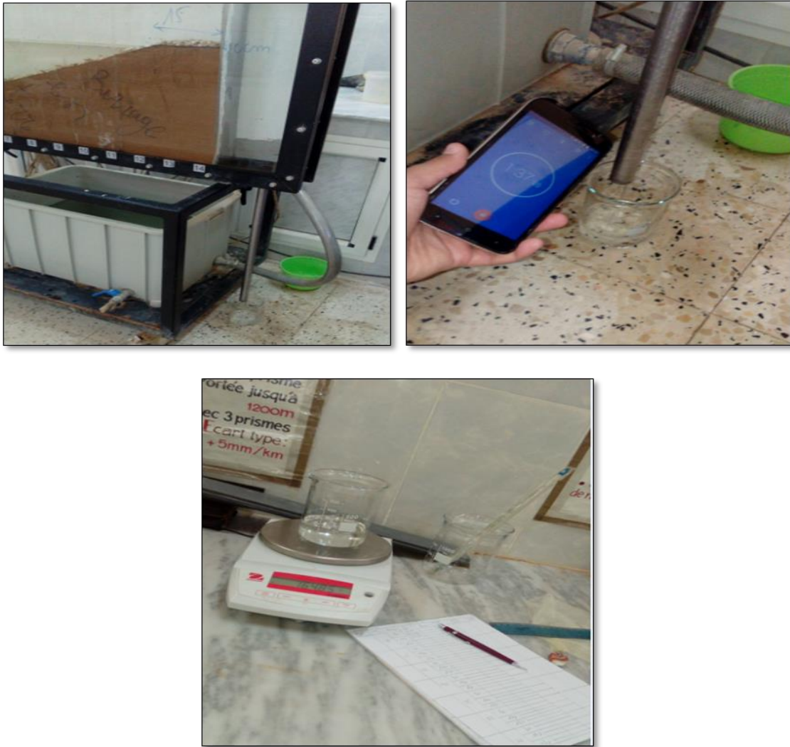
Fig. II. 5. Etapes de mesure le débit d'infiltration à travers un barrage en terre.
