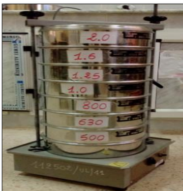
Photo. II. 3. Étapes d'analyse granulométrique à l'utilisation de la série de tamis et agitateur.
