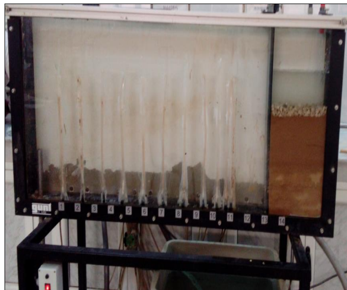
Photo. II. 5. Mesure de la perméabilité verticale.
