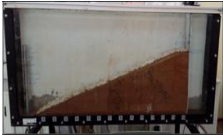
Photo. III. 2. Barrage en terre homogène sur une base imperméable ( bc = 10 cm).
