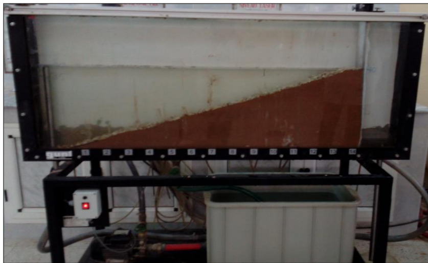
Photo. III. 1. Barrage en terre homogène sur une base imperméable ( bc = 5 cm).
