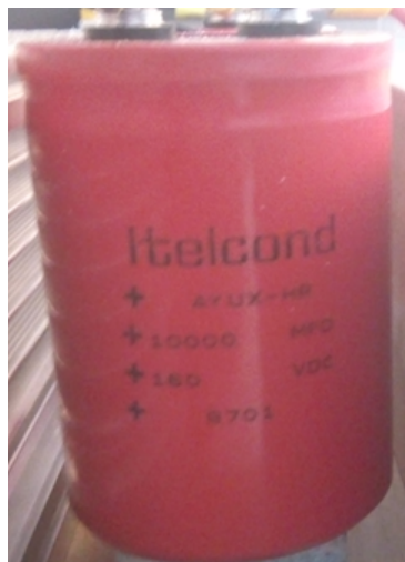
FIGURE 3.30 – Capacité (système de filtrage)
