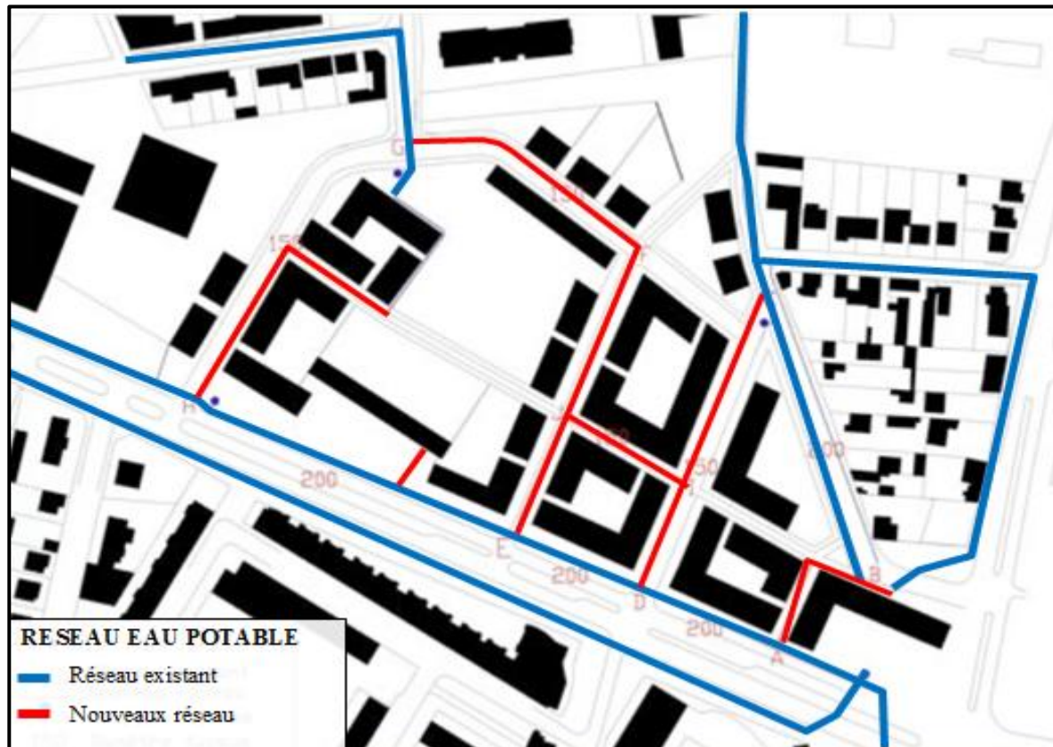
Fig 71: Plan des eaux potable (source: PDF, Dossier d'Opération, Projet de rénovation urbaine du quartier de Mermoz Nord, Lyon 8 ème , page 73) traité par auteurs.
