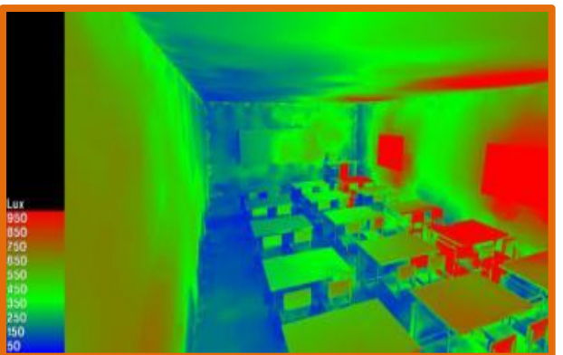
Figure 178 : Rendu numérique de l'éclairéme nt intérieur en faul se couleur cas initial Source : auteur
