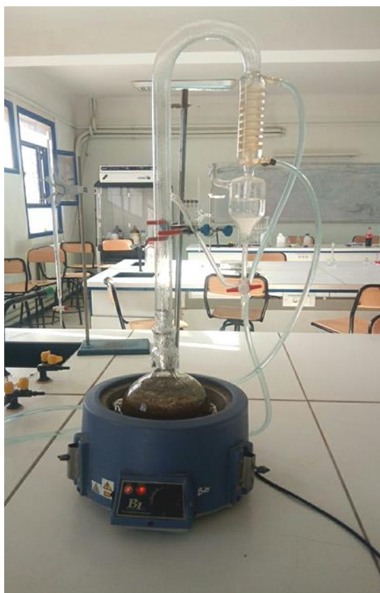
Figure 07 : Montage d'un hydrodistillateur de type Clevenger (Photo originale, 2021).
