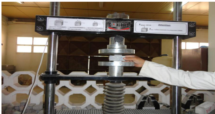
Figure II.11 : Photo de la presse avec dispositif de compression
