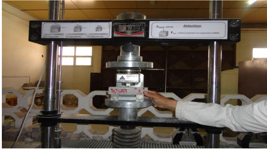
Figure II.9: Photo de la presse avec dispositif de flexion
