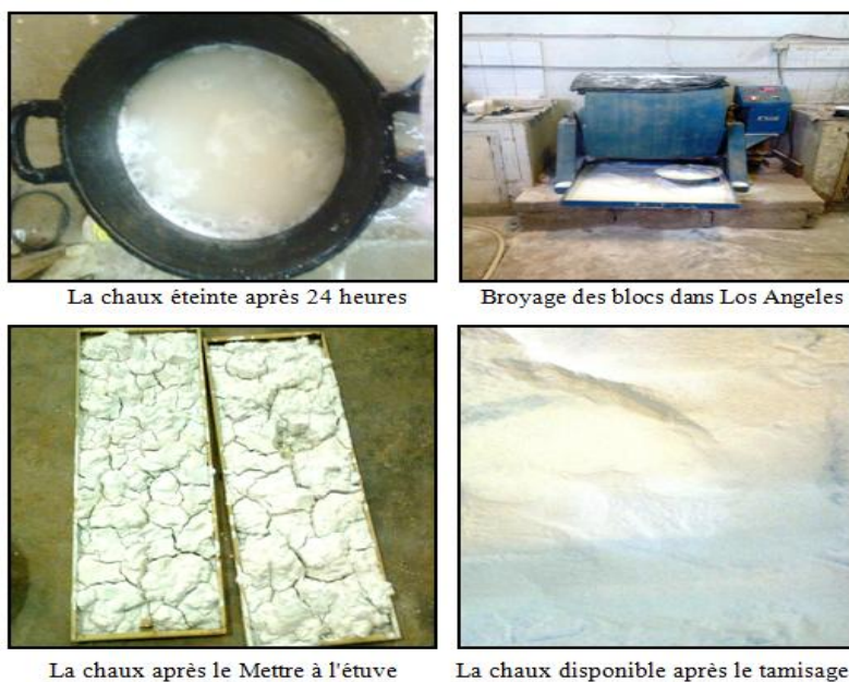
Figure II.10 Préparation de la chaux éteinte
