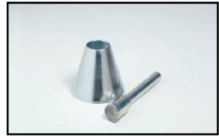
Figure II.9 Moule et d'ame pour Le coefficient d'absorption
