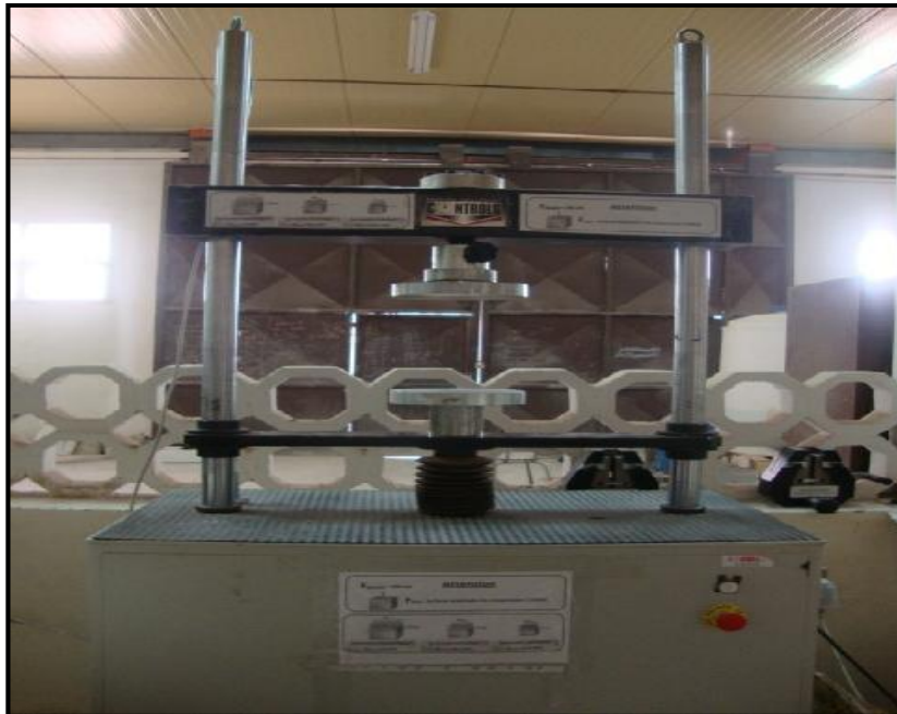
Figure II.17 Machine utilisée pour la mesure de la résistance à la flexion et compression.
