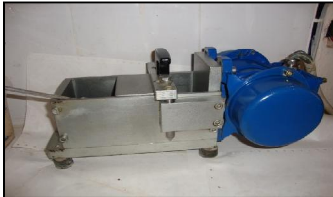
Figure II.15 Maniabilimètre LCL type « B » utilisé pour la mesure de la maniabilité
