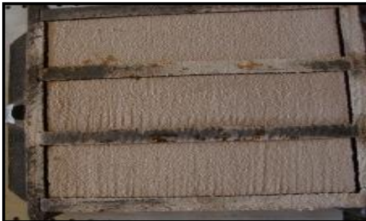
Figure II.12 Moules prismatiques utilisés pour fabriquer les éprouvettes en mortier de chaux
