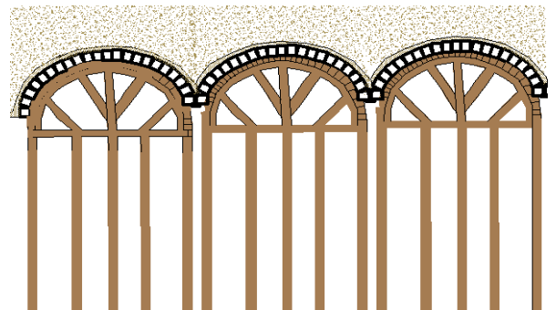
Fig. III.A.27. étalement des voutains
