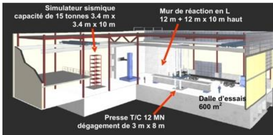
Fig III 07 : Laboratoires de structure
