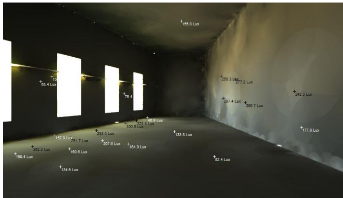
Figure V 81 : Vue Intérieure à 12 :00 h Source : Auteurs
