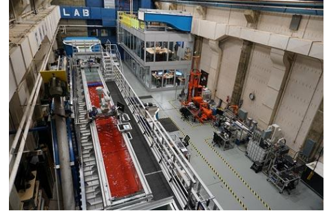
Fig III 01 : Système de canal multifonction
