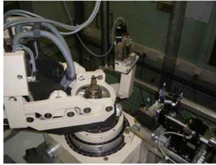
Figure II. 3 : Donnant la photo du montage en géométrie Schultz, (montage 4 cercles)
