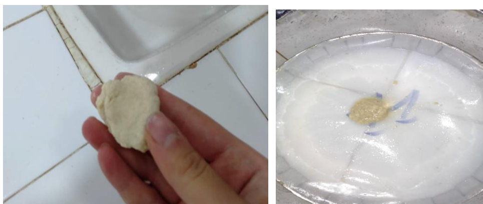
Figure 8 : Formation de pâte (à gauche) et lixiviation manuelle de l'échantillon sous un mince filet d'eau (à droite.) (Original, 2022)
