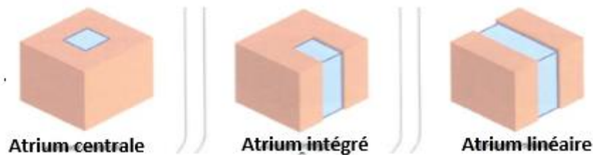
Figure 178: typologies d'atrium Source : PDF l'éclairage naturel
