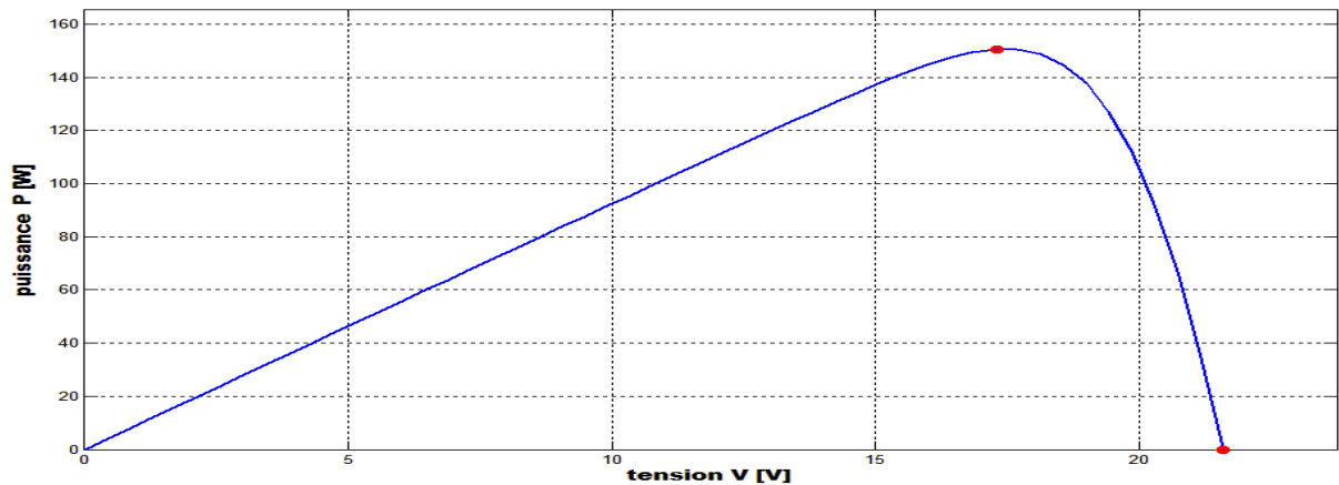
Figure I - 9 : Caractéristique puissance-tension (P-V) du module [7]
